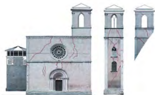
Figura 5.27: Schema fessurativo della facciata e del campanile (Gruppo di Lavoro NCP, S. Grimaz coord., 2010).
