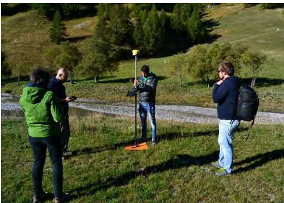
Figura 4.17: Misurazione GPS dei GCPs.
