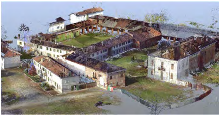
Figura 2.5: Esempio di risultato ottenuto dall'unione di scansioni laser (Spanò & Chiabrando, 2016).
