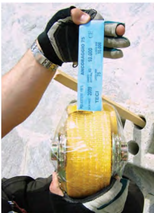
Figura 5.23: Esempio di fasce in poliestere impiegate per la tirantatura (Gruppo di Lavoro NCP, S. Grimaz coord., 2010).
