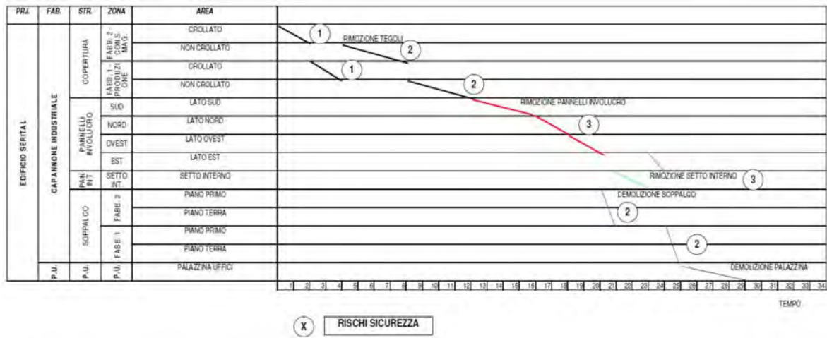
Figura 5.17: Programma delle demolizioni con il diagramma flow-line con rischi fondamentali (Bragadin, 2013).
