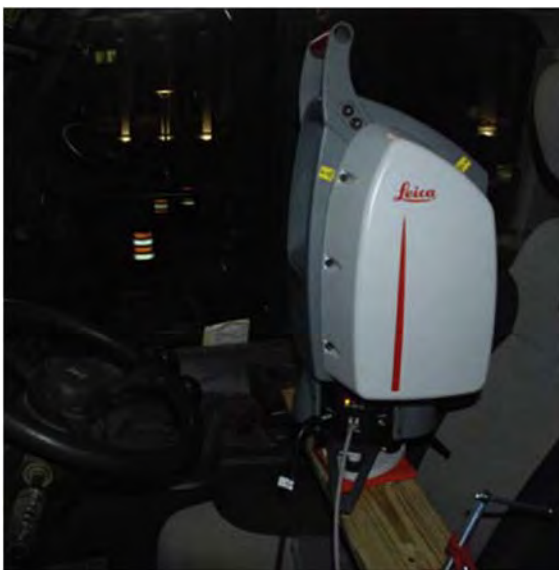
Figura 2.14: Leica ScanStation 2 utilizzata all'interno della cabina di guida (Teizer, et al., 2010).
