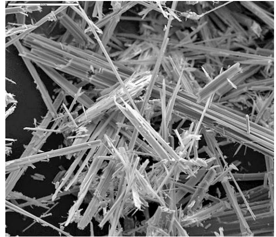
Figura 2.27: Scansione al microscopio elettronico di fibre di amianto della serie degli anfiboli (Fonte: www.saluteinternazionale.info/ ).
