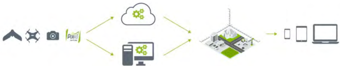
Figura 4.19: Illustrazione del workflow del software Pix4D; i dati vengono catturati utilizzando un drone ad ala fissa, ad ala rotante o per mezzo di una normale fotocamera, successivamente vengono elaborati in cloud o in locale, viene poi restituito un modello 3D che è possibile condividere su diversi supporti informatici (Pix 4D SA, 2017).
