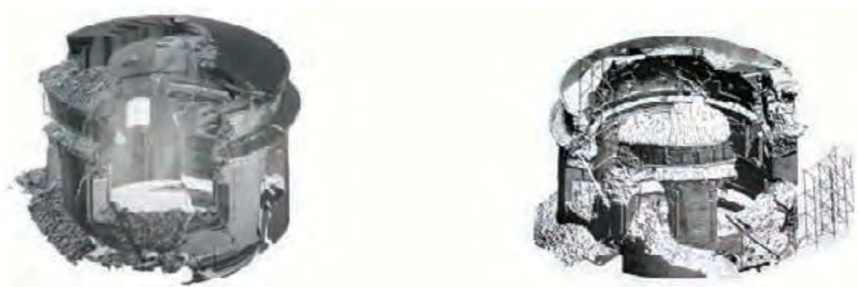
Figura 7.2: Rilievo laser scan del tiburio e inserimento dei telai metallici per il ripristino della continuità dei setti crollati (Gruppo di Lavoro NCP, S. Grimaz coord., 2010).
