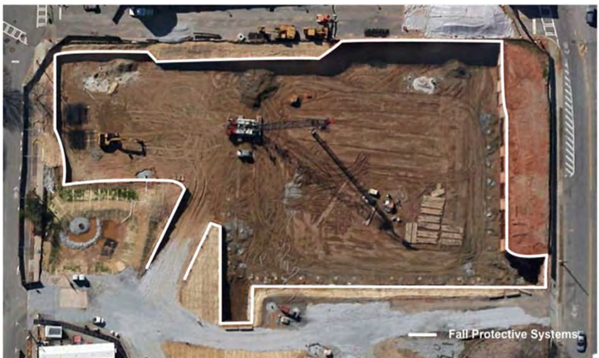
Figura 2.7: Pianta del cantiere oggetto dell'indagine e perimetro per la disposizione di dispositivi di protezione anticaduta (Wang, et al., 2015).
