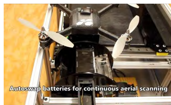
Figura 8.5: La piattaforma di atterraggio e decollo implementa un sistema di sostituzione automatica delle batterie (Identified Technologies, 2016).
