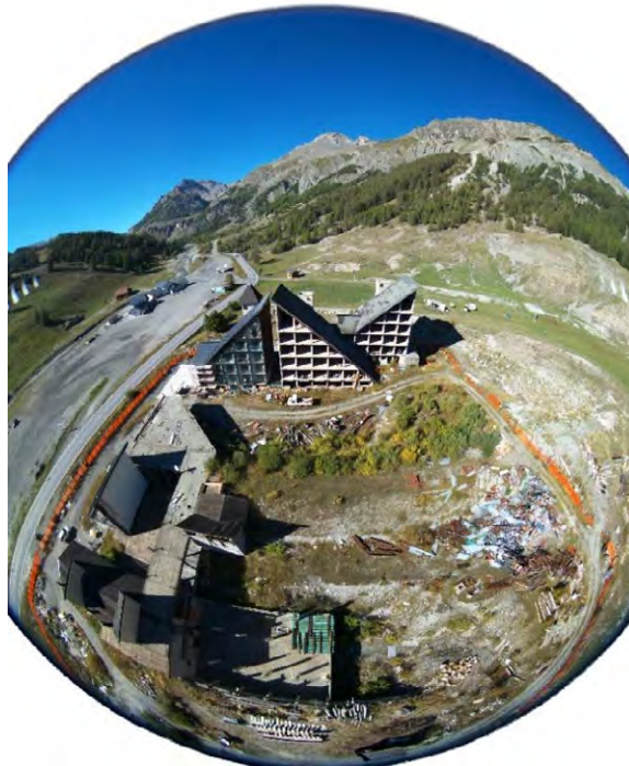
Figura 4.20: Un esempio di immagine “fish eye” non correttamente gestita da PhotoScan. La distorsione prospettica è direttamente proporzionale alla distanza dal centro dell'immagine.
