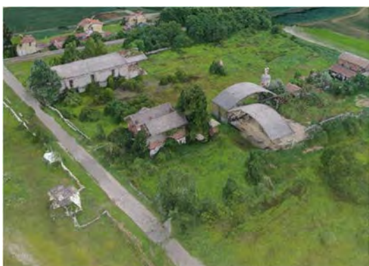
Figura 2.28: esempi di dati acquisiti tramite drone (modelli di nuvole di punti) per il rilievo di amianto in Piemonte (ARPA Piemonte, 2016).
